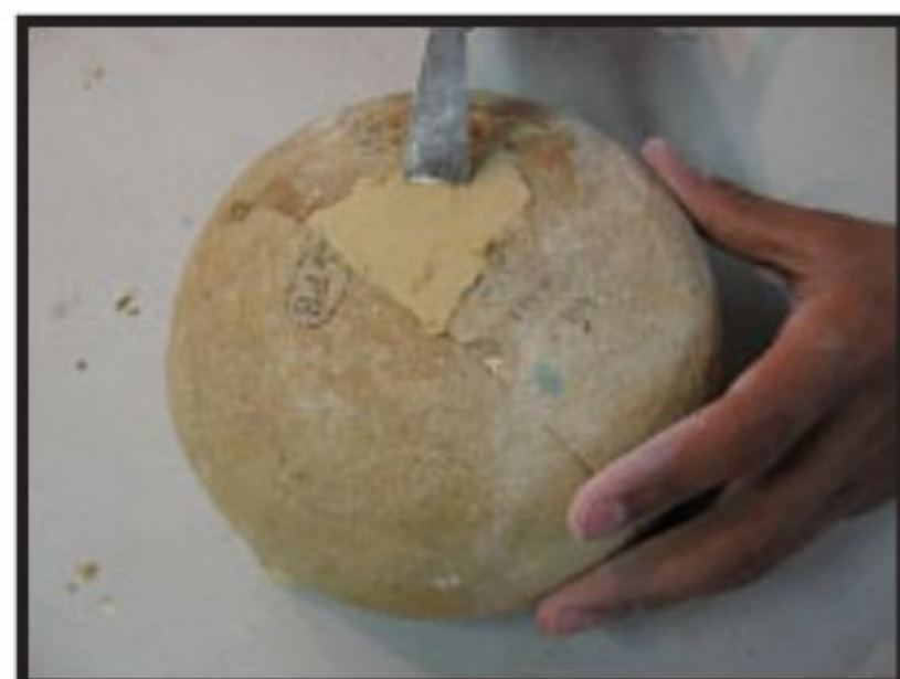
۹- برداشتن ملات گچی (۵/۵۷ درصد گچ اصفهان، ۱۲ درصد گچ سمنان، ۲۸/۵ درصد پودر آجر نخودی رنگ، ۱/۷ درصد رنگ اکری، ۰/۳ درصد رنگ اخرا) اضافی و پرداخت.
