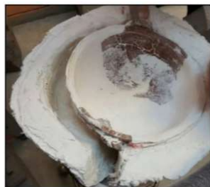
تصویر ۱۲ (راست)- تراش کاری خمیر گچی سفت شده تصویر ۱۳ (چپ)- خارج ساختن سفال از قالب دوتکه ای پس از خشک شدن کامل خمیر گچی به منظور شکل دهی و صیقل کاری
