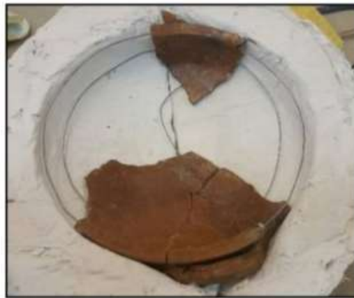
تصویر ۱۱- قرار دادن مفتول های فلزی مابین دوتکه بافاصله حدود ۵/۰ سانتیمتر بالاتر از سطح قالب
