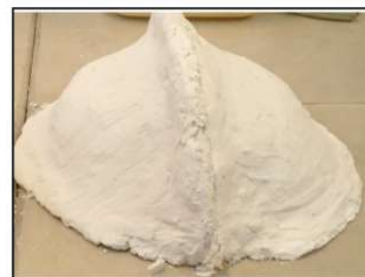
تصویر ۹- اتصال دوتکه قالب به هم به کمک خمیر گچ
