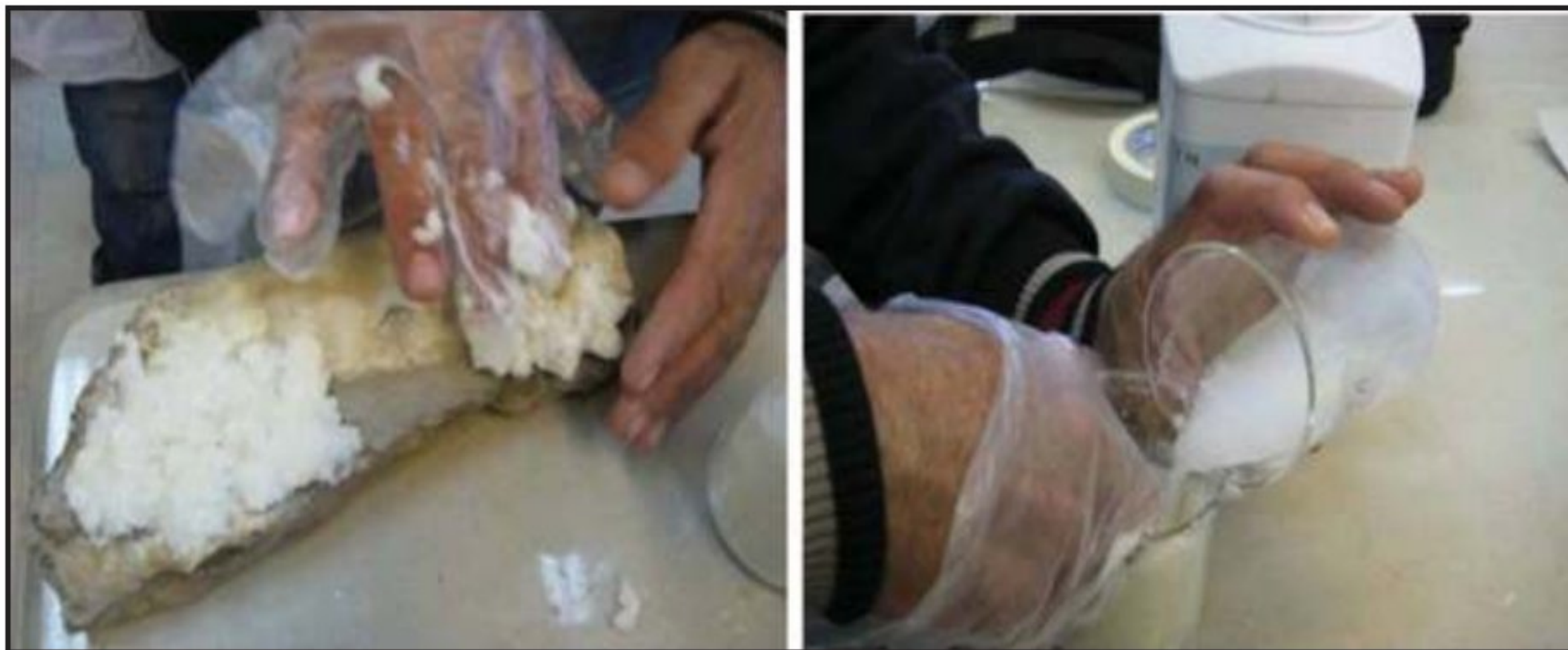
ت. ۱۰. تهیه خمیر CMC و 25% EDTA و قرار دادن آن روی اثر (ماخذ: نگارندگان)
