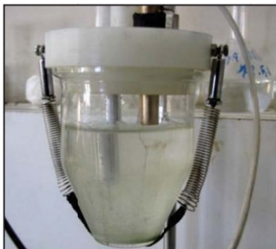
شکل (۳-۲): الکتروودهای برنزی تهیه شد به روش ریخته‌گری با درصد (Cu-10Sn)
