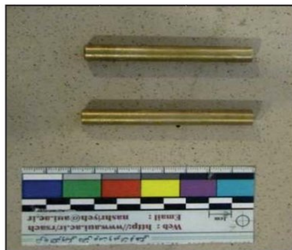
شکل (۳-۲): الکتروودهای برنزی تهیه شد به روش ریخته‌گری با درصد (Cu-10Sn)
