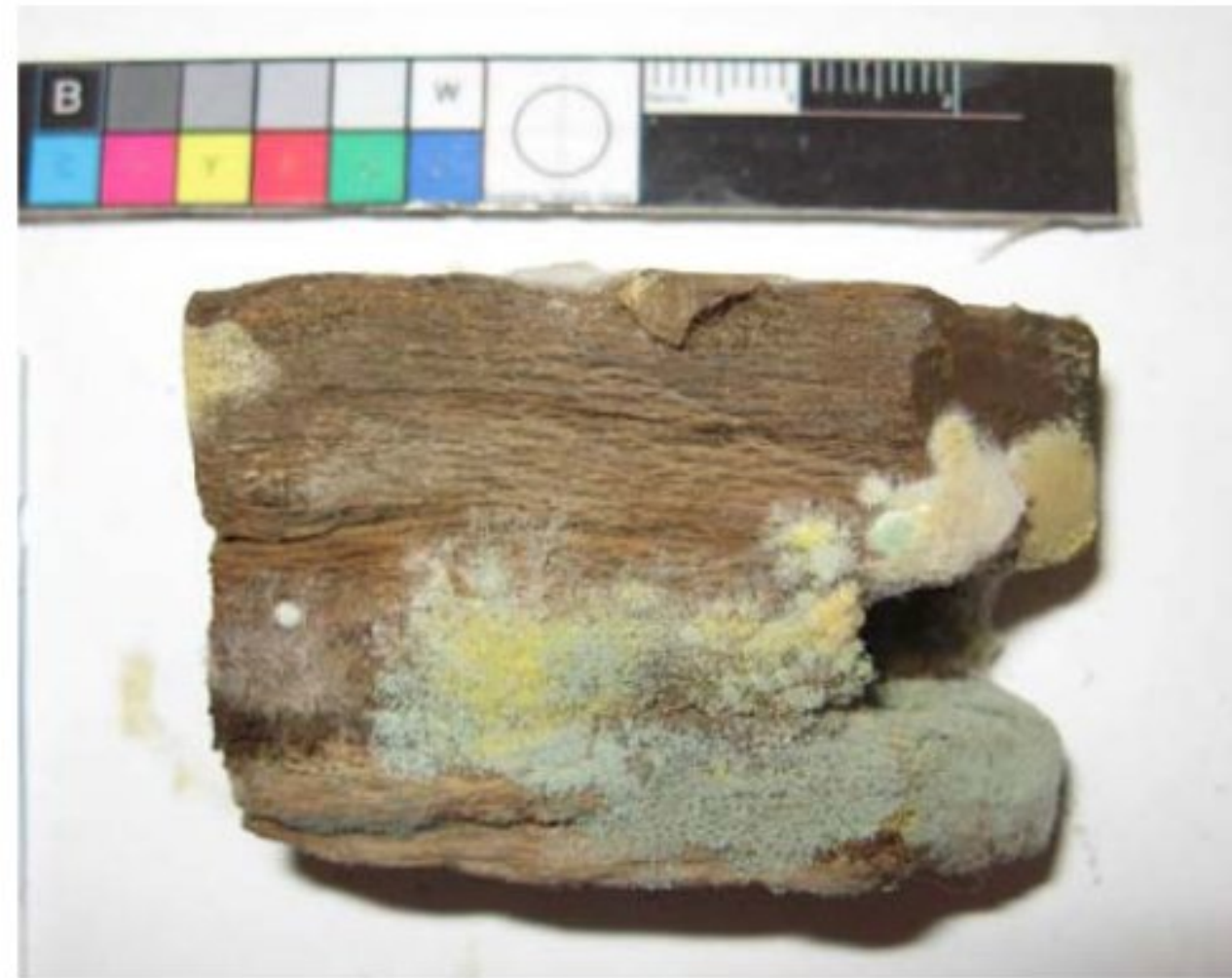
تصویر ۸- رشد کپک ها روی نمونه ی اثر چوبی در آزمایشگاه
