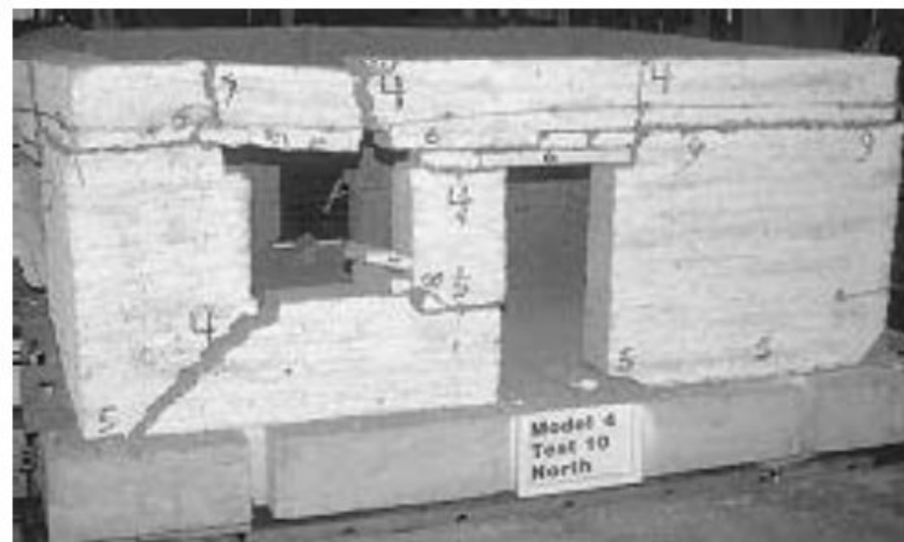
شکل ۵: بررسی رفتار سازه در مقیاس ماکت
