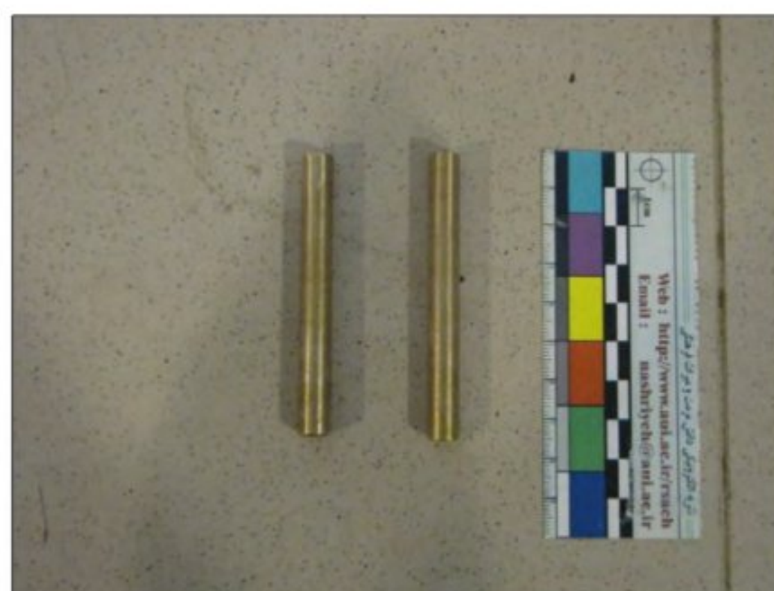
تصویر (۱) : الکترودهای تهیه شده برای برش کوپن ها
