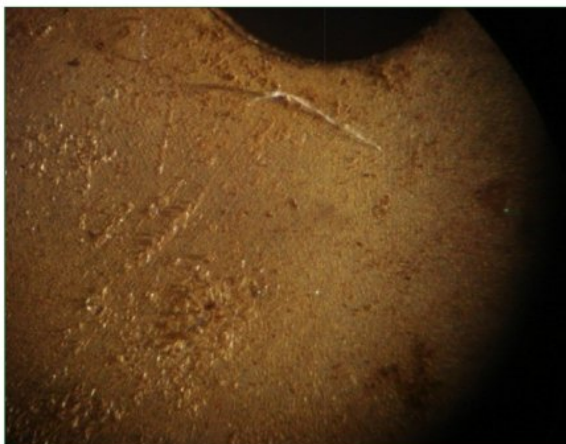
تصویر (۶): کوپن در حضور بازدارنده اقاکیا با غلظت ۱۰۰۰ ppm بعد از ۳۰ روز غوطه وری . بزرگنمای ۶۰ X
