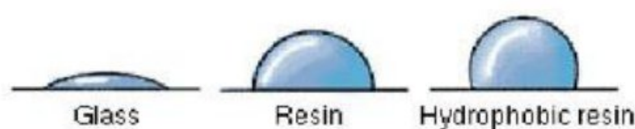
شکل ۴- زاویه‌ی تماس قطره‌ی آب با سطوح شیشه، رزین و رزین آب‌گریز
