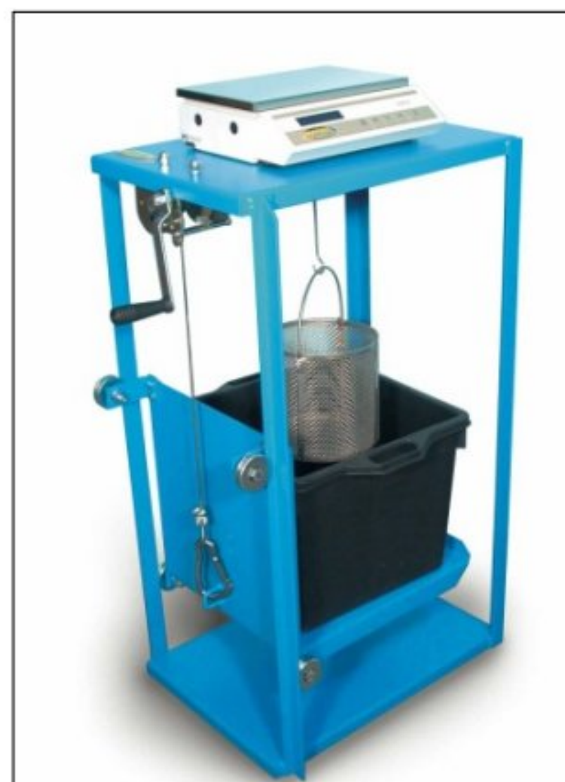
تصویر ۶. ترازوی هیدرو استاتیکی برای نمونه‌های فله‌ای و بزرگ ( http://www.mastest.com )
