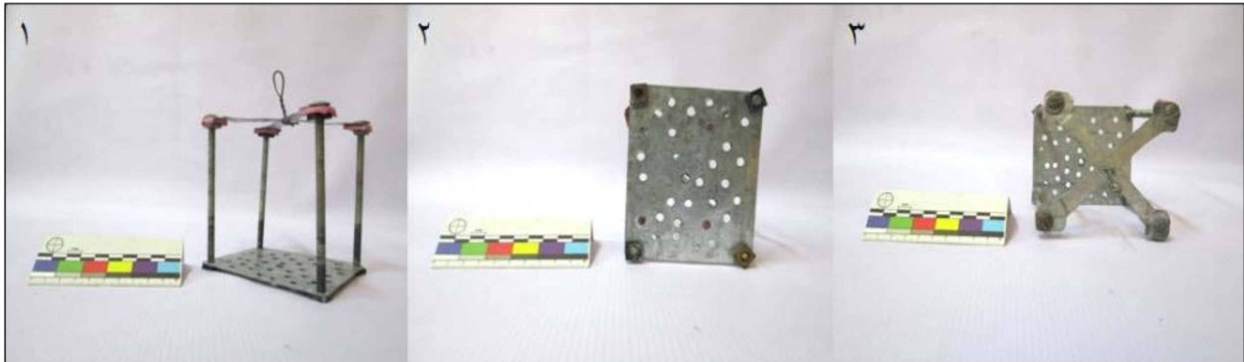
تصویر ۹. قفسه نگه‌دارنده نمونه به همراه جزئیات ساخته‌شده از جنس فلز، تصویر از سه نمای کلی قفسه
