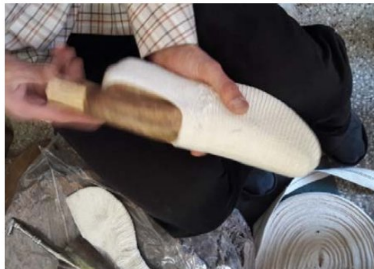
تصویر ۸- قالب زدن رویه گیوه
