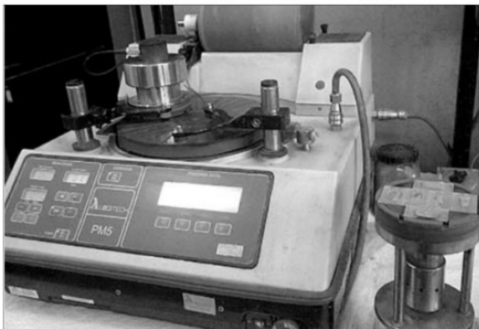
شکل ۴: دستگاه ساب برای سایش مقاطع نازک تا رسیدن به ضخامت مورد نظر.
