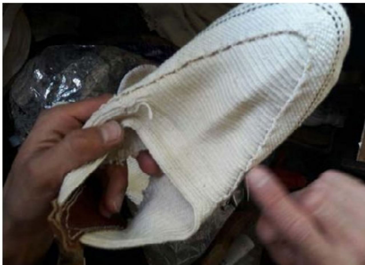
تصویر ۱۱- اتصال نوار به رویه و پاره کردن قسمت پاشنه،
