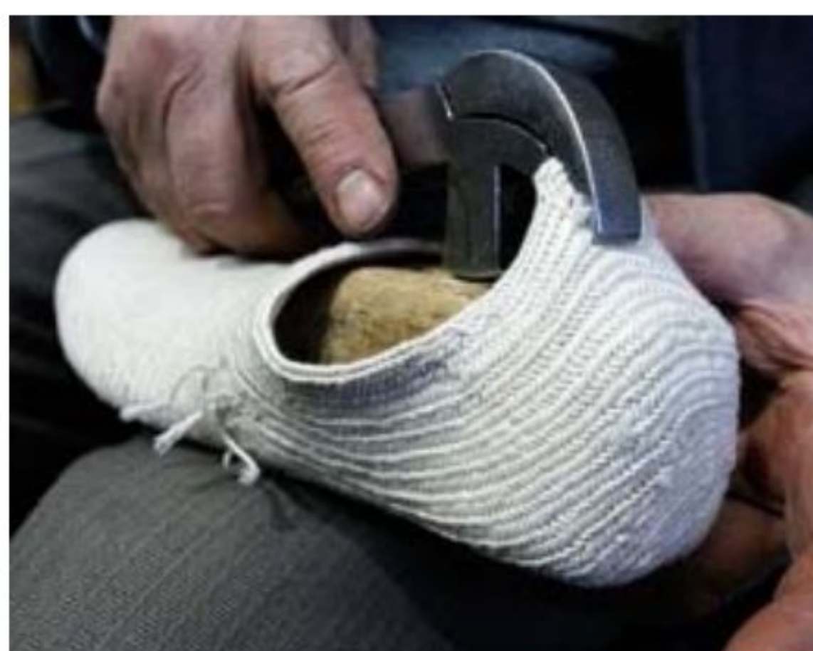
تصویر ۹- شکل دادن رویه در قالب با گاز انبر
